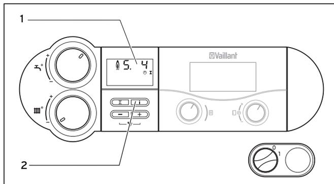
Рис. 4.11 Индикация состояний
