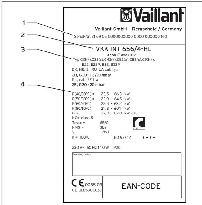
Рис. 1.1 Маркировочная табличка (пример)
